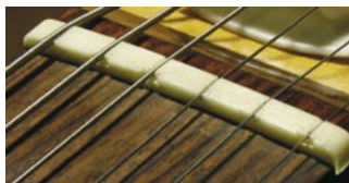
Siodelko kompensacyjne produkcji Stanisława Jopka zamontowane w gitarze typu Telecaster, na której gra Tomasz Ślotała.
